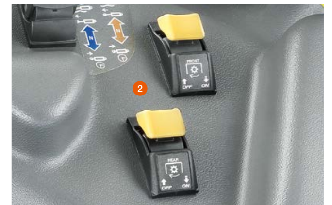
2 Le prese di forza anteriore e posteriore possono essere attivate premendo semplicemente un pulsante.
