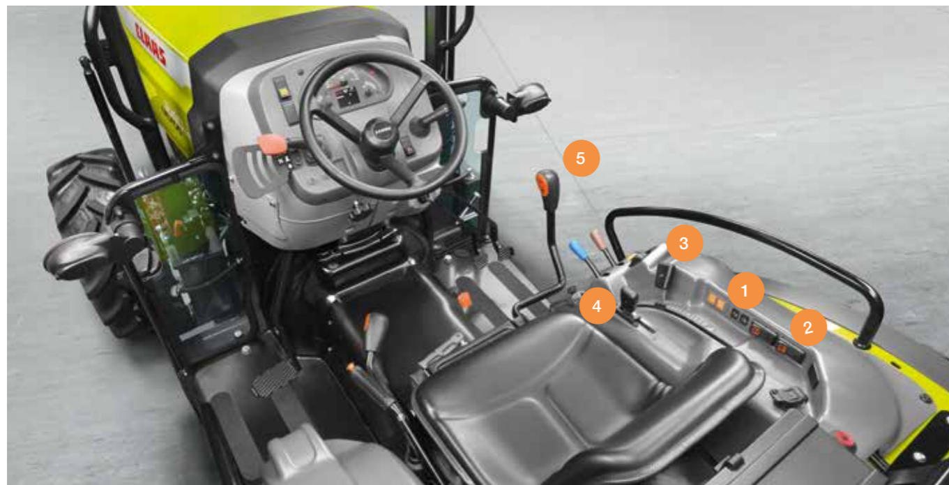
1. Attivazione 4 RM | 2. Memorie motore | 3. Sollevatore meccanico posteriore | 4. Distributori meccanici | 5. Leva del cambio
